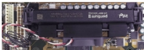
上覆散熱片與風扇、安裝在單邊接觸 CPU 插槽中的 SECC 包裝 Pentium® II 處理器 (俯視圖)
