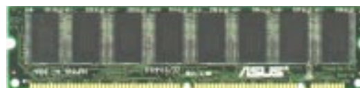
SDRAM DIMM 記憶體模組不含 ECC (共 8 顆記憶體晶片)
