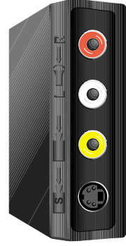
S-Video 影像輸入 (左聲道) 聲音輸入 (右聲道) 輸入
