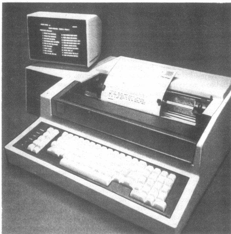
Рис. 1. Микрокомпьютер (микрокомпьютерная система, включающая ЦП, клавиатуру, дисплей, внешнюю память и печатающее устройство)
