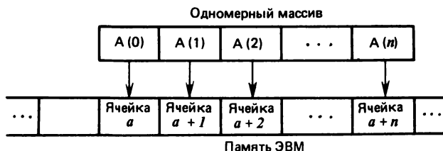
Рис 3.1. Размещение элементов одномерного массива в памяти ЭВМ:
