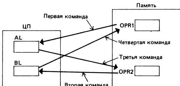
Рис. 3.8. Программный фрагмент для обмена содержимого двух ячеек памяти: а – код; б – предпринимаемые действия
