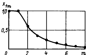
Рис. 3.31. Переходный процесс в нестационарной замкнутой системе
