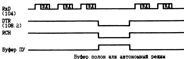
Рис. 2.8. Временная диаграмма передачи данных по запросу (ACK)
