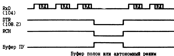
Рис. 2.7. Временная диаграмма передачи данных по сигналу "Готовность". Режим поблочного обмена
