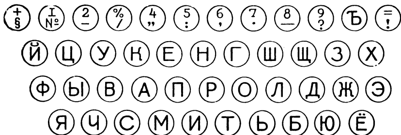
Рис. 2. Стандартное расположение букв, цифр и знаков на клавиатуре пишущей машины с 44 клавишами
