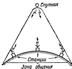
Рис. 15. А так осуществляется связь через спутник. Каждая станция посылает свой пакет и принимает результат ретрансляции пакета спутником. Самая главная проблема здесь заключается в том, чтобы не наложился пакеты, передаваемые различными станциями. Именно для этого необходима адаптация.
