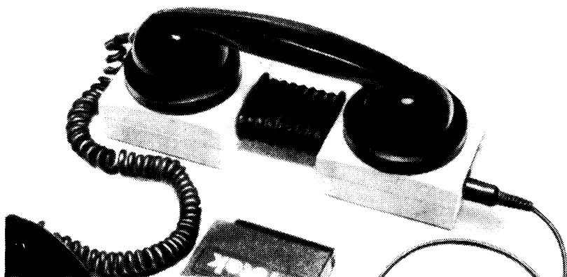
Рис. 13. Модем преобразует импульсные сигналы в звуки низкой частоты, которые передаются по телефонным каналам связи. Модем позволяет удаленной ЭВМ обмениваться данными с центральной базой данных
