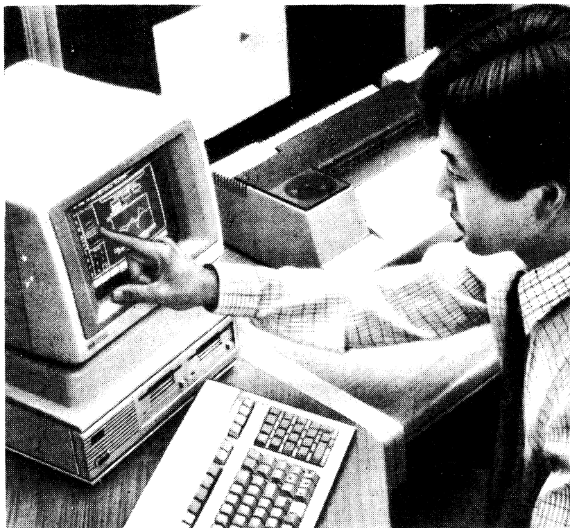
Рис. 11. Располагая необходимыми техническими средствами, пользователь может ввести данные в программу прикосновением пальца руки к экрану дисплея
