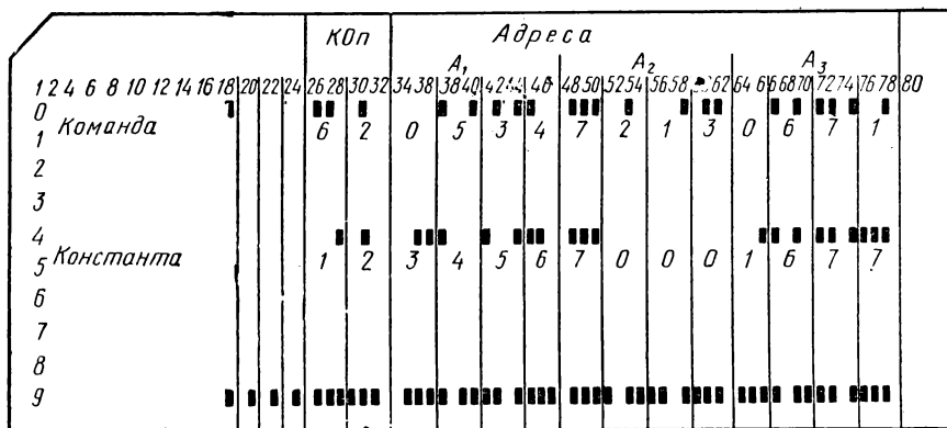
Рис. 1.7. Пример записи команд на перфокарте
