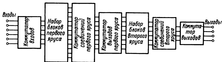
Рис. 3-11. Структурная схема двухъярусного универсального перестраиваемого вычислителя
