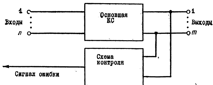
Рис. 5-28. Контроль комбинационной логической схемы путем анализа выходов.
