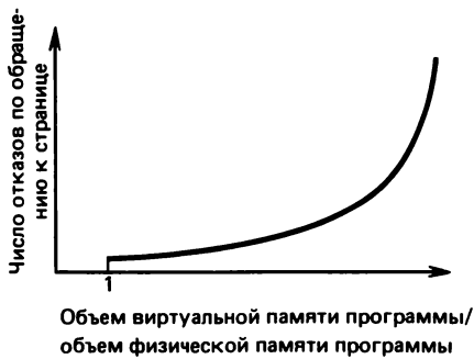
Рис. 6.6. Зависимость числа отказов по обращению к странице от отношения объемов виртуальной и физической памяти программы [5]
