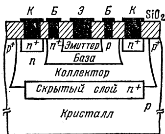
Рис. 1.4. Интегральный биполярный транзистор, изолированный электронно-дырочным переходом
