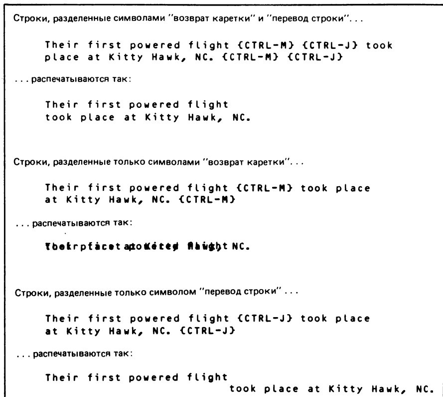
Рис. 11.4. Пример завершения строки текста символами "возврат каретки" и "перевод строки", только символом "возврат каретки", только символом "перевод строки"
