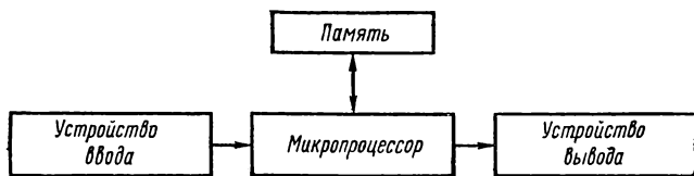
Рис. 1.1. Простейшая схема микрокомпьютера
