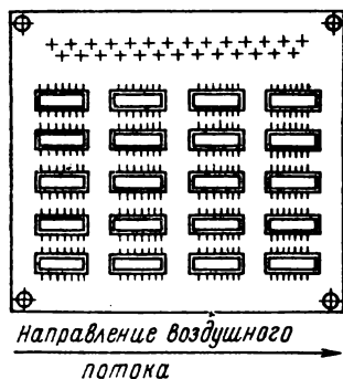
Рис. 6-12. Установка микросхем с учетом направления воздушного потока.
