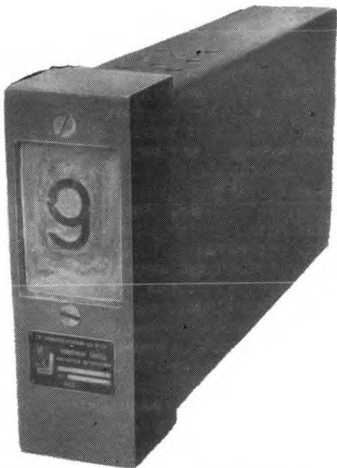
Рис. IV-11. Внешний вид оптического цифрового указателя с проекционным индикатором.
