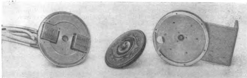
Рис. III-101. Преобразователь с магнитными модуляционными головками в разобранном виде.
