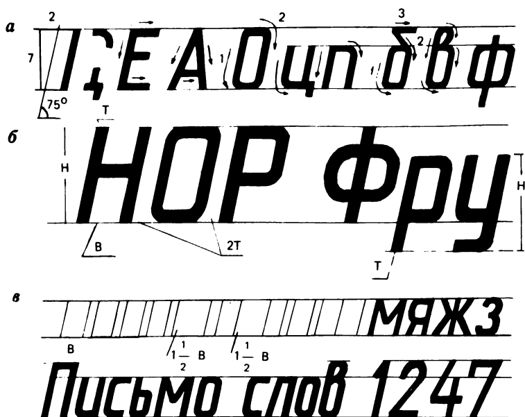
Рис. 3. Образец построения Стандартного шрифта: а – элементы букв; б – нормативы; в – разметка букв и написание слов
