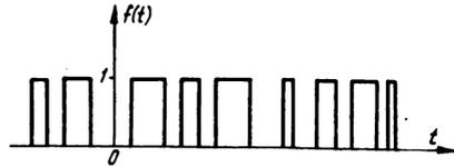
Рис. ПЗ.13. Последовательность импульсов случайной длины.
