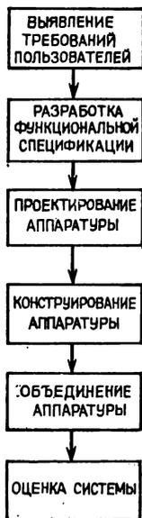
Рис. 1.2. Цикл проектирования аппаратной системы.
