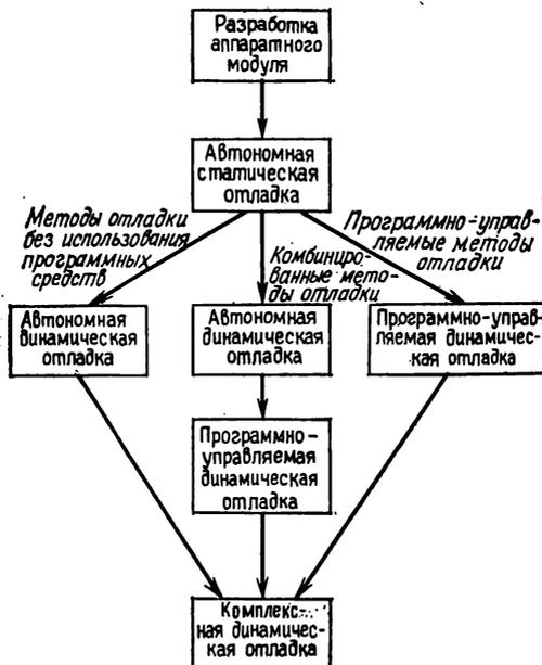
Рис. 9.3. Способы отладки и объединения аппаратных средств.
