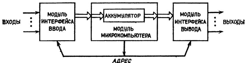
Рис. 6.1. Блок-схема архитектуры МИКРОКОМПЬЮТЕРА Intel 8085.
