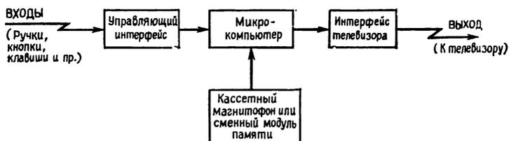
Рис. 11.1. Схема телевизионной игры с применением микрокомпьютера.
