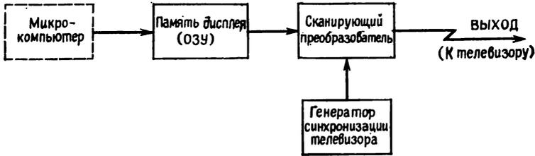
Рис. 11.3. Интерфейс телевизора.
