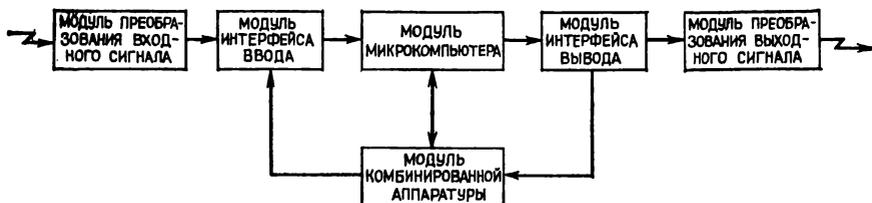
Рис. 3.1. Общая модульная структура аппаратных средств микрокомпьютерной системы.
