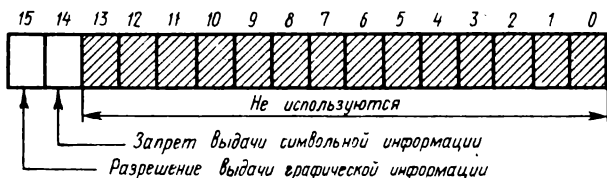
Рис. 1.5. Формат регистра управления контроллера графического дисплея
